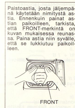
Paistoastia, josta jäljempänä käytetään nimitystä astia. Ennenkuin painat astian paikoilleen, tarkista, että FRONT-merkintä on kuvan mukaisessa reunassa. Paina astia niin syväälle, että se lukkiutuu paikoilleen.
